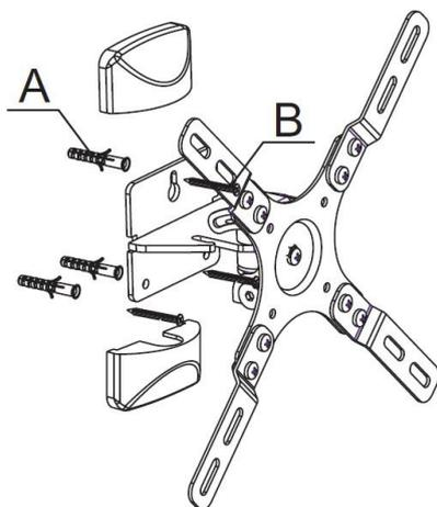
Usando el nivel de burbuja, asegúrese que la placa de pared esta nivelada, taladre dos agujeros con una broca de 10 mm y una profundidad de 50 mm. Inserte los anclajes de pared en los orificios. Luego utilice los pernos largos B y los tacos tipo A para dejar fijado a la pared la placa de sujeción principal.
