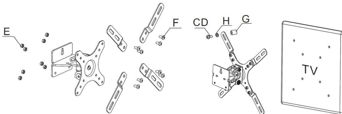
En caso de que su televisor requiera un sistema de fijación VESA superior a 100x100, coloque las aspas accesorias en la base, utilice para ello los tornillos F y las tuercas E correspondientes.
