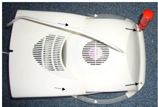
3. Levantar la carcasa dejando la parte delantera con el cristal cerámico sobre la superficie.
