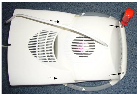
3. Das Gehäuse aufstellen, dabei das vordere Teil mit der Ceramic Glasscheibe auf der Unterlage liegen lassen.
