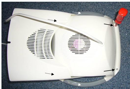
3. Redresser le boîtier, en laissant reposer la partie avec la vitre en céramique sur le support.
